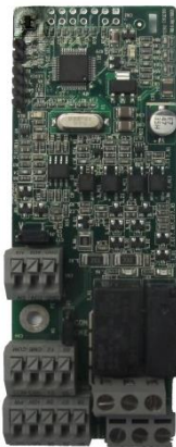
IO expansion card EC-IO501-00
